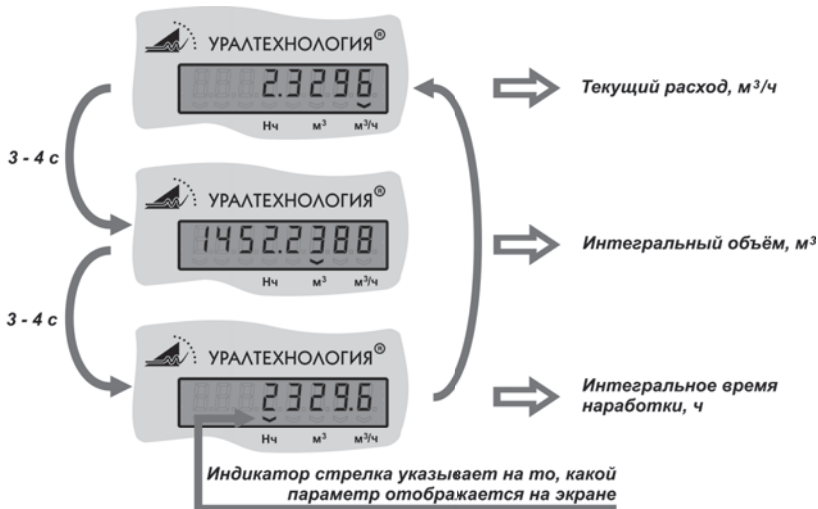
Рисунок 1.14 – Отображение информации на ЖКИ расходомера
